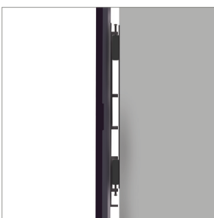
Montaż w odległości 65mm od ściany pozwala na łatwy dostęp do złączy
